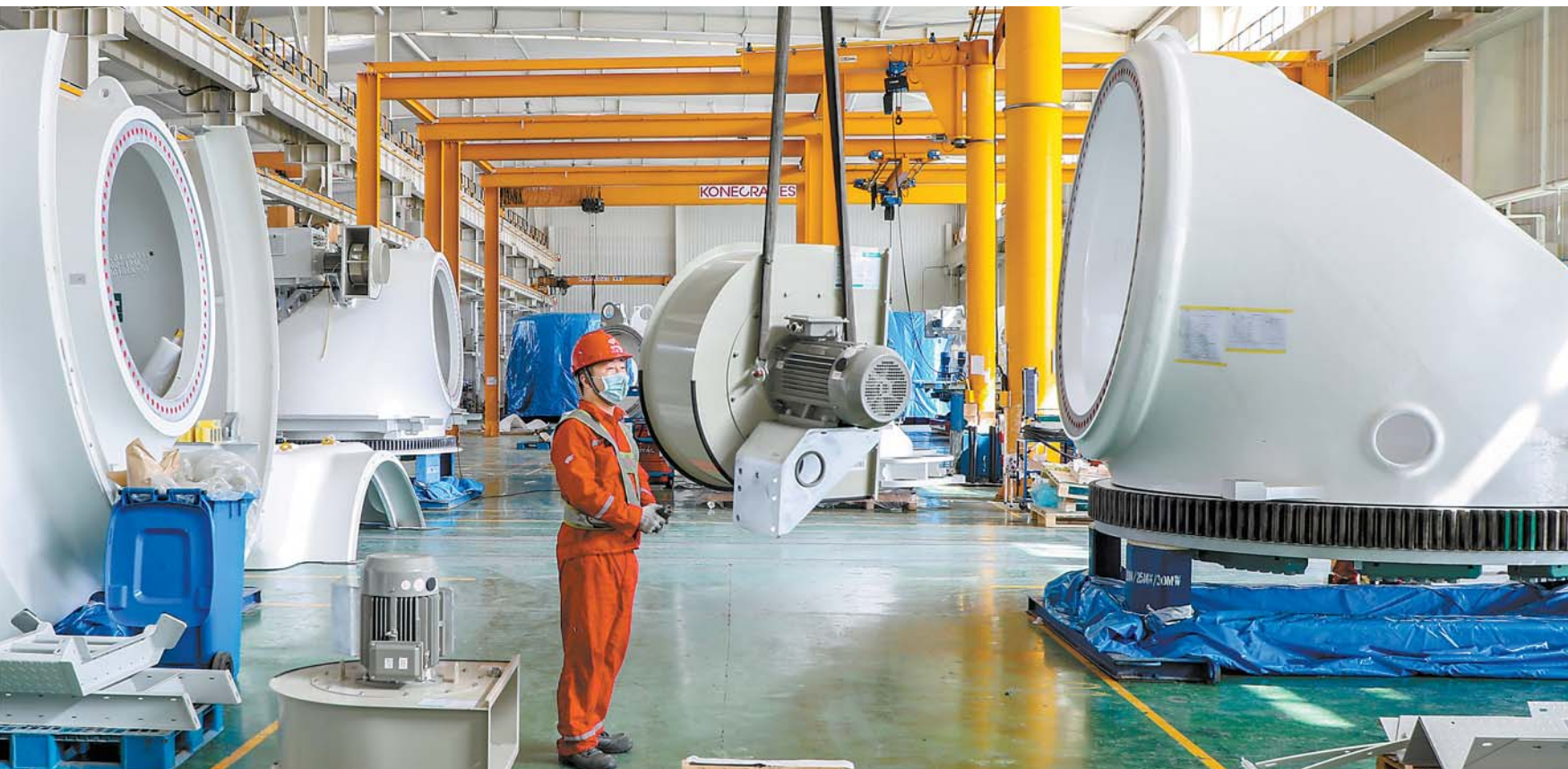
4 - ئاينىڭ 23 - كۈنى، قومۇل يۇقىرى، يېڭى تېخنىكىلىق كەسىپلەر تەرەققىيات باغچە رايونىدىكى قومۇل جىنيەڭ شامال ئېلېكتر ئۇسكۇنىلىرى چەكلىك شىركىتىنىڭ ئىشلەپچىقىرىش بىخىدا ئىشچى كەنپىراتور سوۋۇتۇش شامال دۇرغۇچىنى ئاسما توشۇغۇچى توشۇماقتا. بۇ شىركەت پۈتۈن مەملىكەتتە ھەرقايسى جايلاردىن كەلگەن زاپ - كازىلارنى قېسىپ قوشۇپ ئىشلەپچىقارماقتا. □ لياۋ ياۋيۇ فوتوسى
